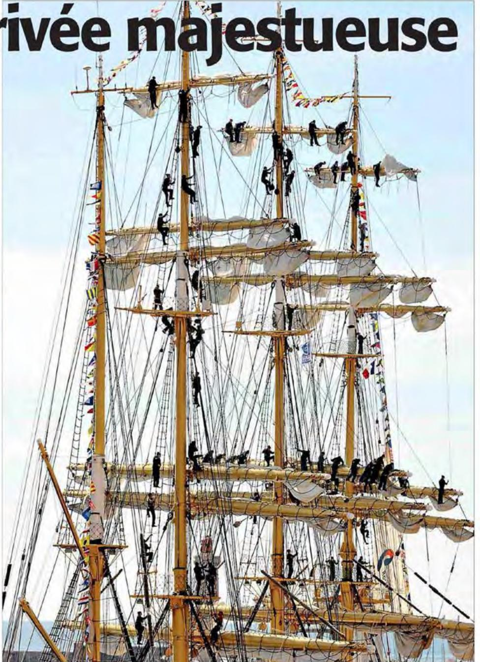
■ Les cadets du Kruzenshtern sont montés dans la mâture du quatre-mâts russe à leur arrivée dans le port de Sète. Une manœuvre délicate et spectaculaire qui permet de ranger les voiles le long des vergues.
